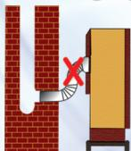
(۱۷) تحت هیچ شرایطی سطح دودکش داخل ساختمان نباید پایین تر از سطح لوله بخاری قرار گیرد در این صورت نصب بخاری توسط سرویسکار منوع بوده تا زمانی که دودکش ساختمان توسط افراد ذیصلاح اصلاح گردد.
