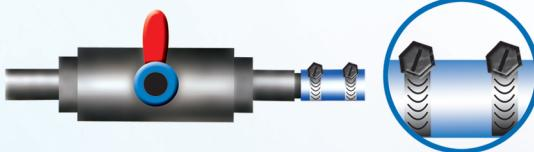
(۱۱) هر سه ماه یکبار و هنگام تعویض محل نصب بخاری و یا تعویض کپسول احتمال نشت گاز را توسط کف صابون در محل اتصالات کنترل نمایید.
